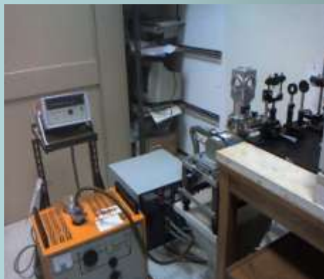
•Un système de vide et détection de fuite
