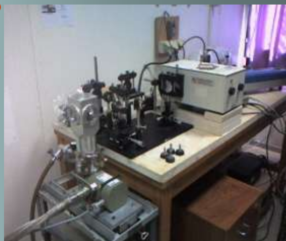
•Un banc de photoluminescence
