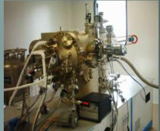
**B/** Expertise par diverses techniques de spectroscopie optique (photoluminescence avec excitation laser, excitation de la photoluminescence avec laser Ti-Sapphire, absorption optique et spectroscopie en temps résolu et photoréflexivité) des matériaux et nanostructures.
